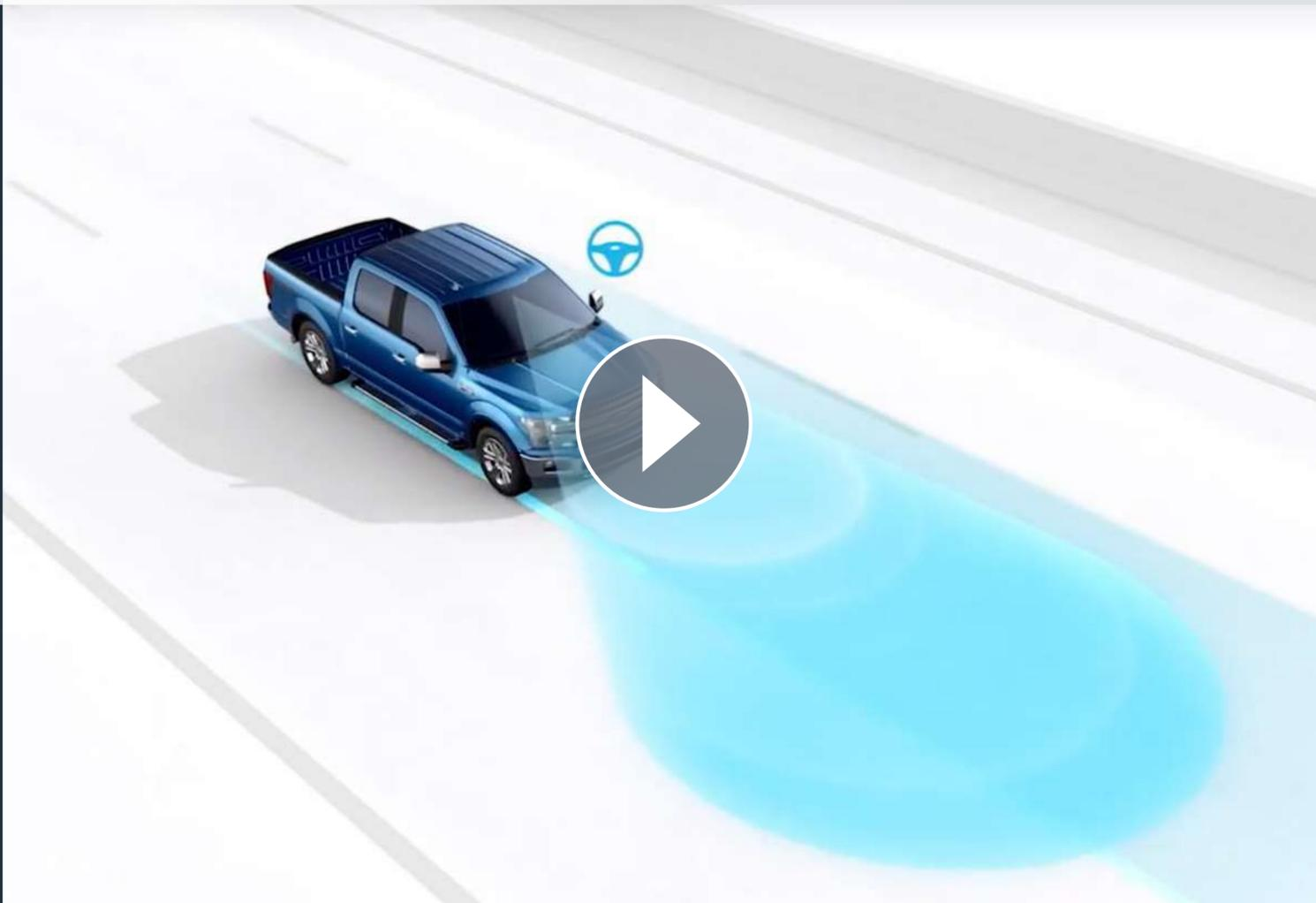
Ayuda a los conductores a mantenerse en el carril. El sistema para mantenerse en el carril usa una cámara instalada detrás del espejo retrovisor del parabrisas para monitorear las marcas de los carriles de la carretera y detectar los desvíos involuntarios fuera del carril. Si la cámara detecta un inminente desvío involuntario, el sistema usará la dirección y la pantalla del panel para alertar al conductor y/o mantenerlo en su carril.
