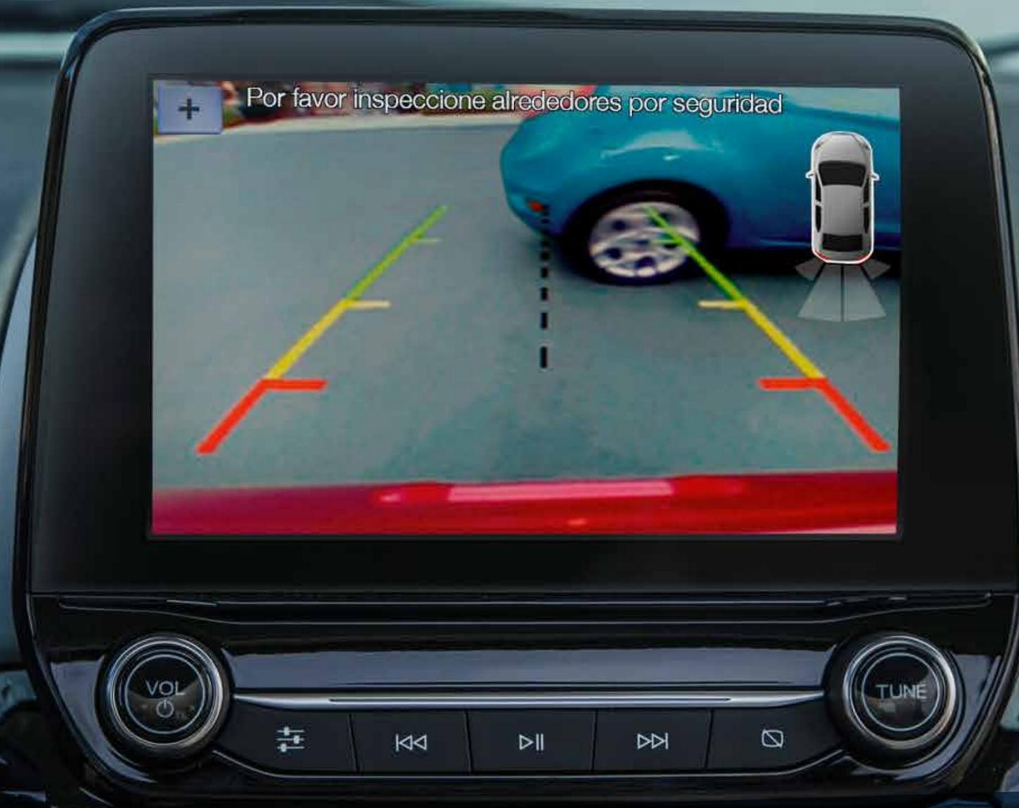
Al colocar marcha atrás, la cámara ubicada en la parte trasera de la Nueva Ecosport mostrará, en la pantalla central multi-táctil flotante de 8", todo lo que se encuentre detrás del vehículo. Esto le permitirá al conductor realizar las maniobras con mayor control y seguridad.
