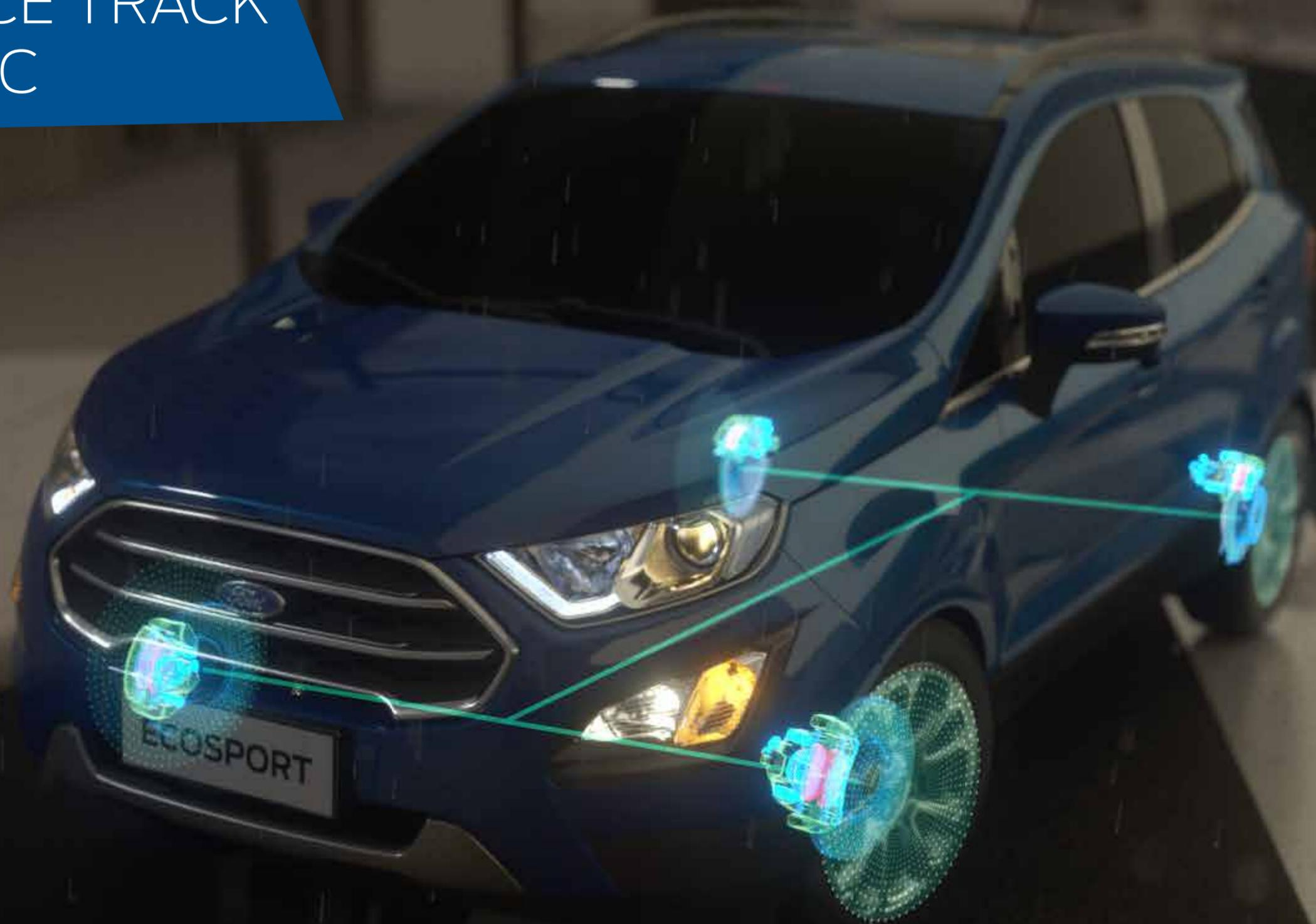
Este sistema premium, exclusivo de Ford, funciona a través de sensores cuya función es medir y obtener el ángulo de deriva y desplazamiento de la carrocería en tiempo real (100 mediciones por segundo). En caso de detectar una irregularidad, aplica los frenos de forma individual y reduce la potencia del motor para mantener el control y estabilidad del vehículo.
