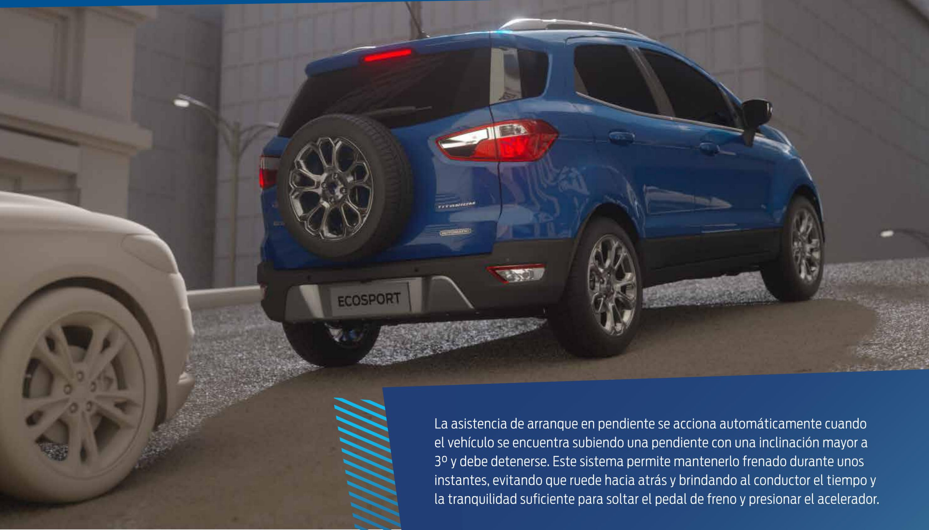
La asistencia de arranque en pendiente se acciona automáticamente cuando el vehículo se encuentra subiendo una pendiente con una inclinación mayor a 3° y debe detenerse. Este sistema permite mantenerlo frenado durante unos instantes, evitando que ruede hacia atrás y brindando al conductor el tiempo y la tranquilidad suficiente para soltar el pedal de freno y presionar el acelerador.
