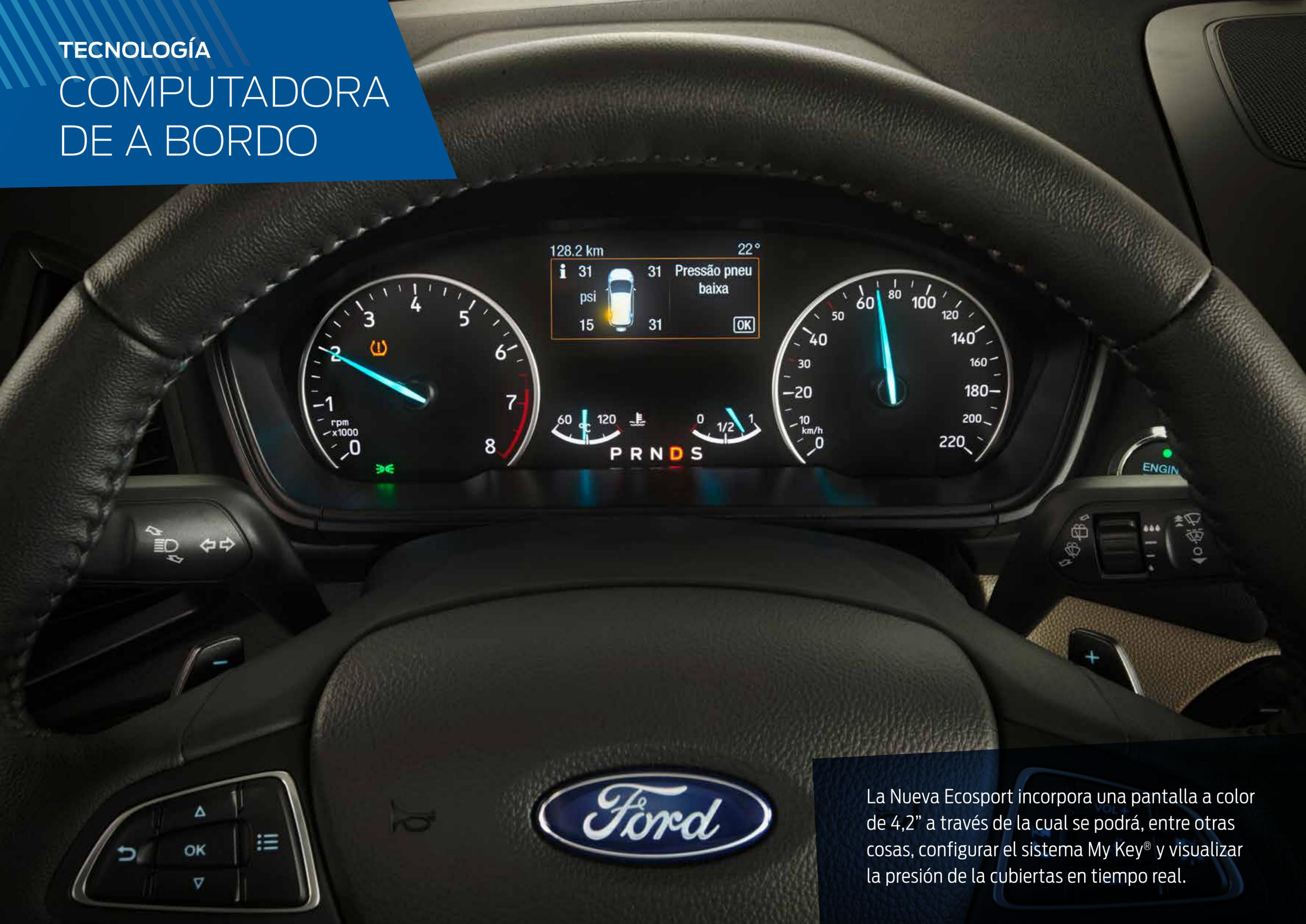
La Nueva EcoSport incorpora una pantalla a color de 4,2" a través de la cual se podrá, entre otras cosas, configurar el sistema My Key® y visualizar la presión de las cubiertas en tiempo real.
